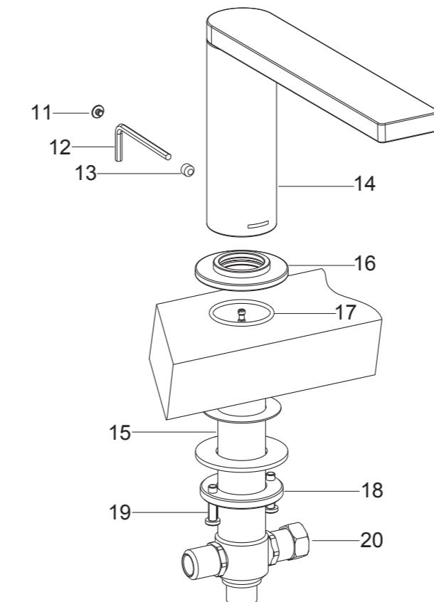
将O型圈(17)嵌入装饰盖(16)底部凹槽。从台面上方将装有O型圈的装饰盖旋紧在切换器组件(15)上且紧贴台面。调整切换器组件位置，使得螺母(20)在右边。旋紧螺母(18)，拧紧螺钉(19)，固定切换器组件。
