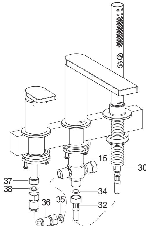
将垫片(34)装入软管(32)螺母内，与切换器组件(15)连接。
